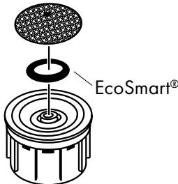
**D** Bei Problemen mit dem Durchlauferhitzer oder wenn mehr Wasserdurchsatz gewünscht wird, kann der EcoSmart® (Durchflussbegrenzer), der hinter dem Luftsprudler sitzt entfernt werden.
